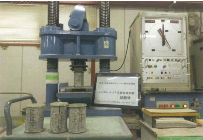
(圧縮試験状況写真)
