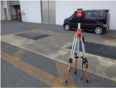
[写真 D]不同沈下調査状況
