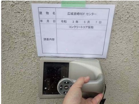
[写真 D] 配筋確認状況
